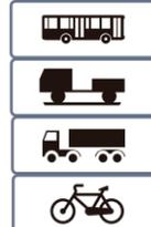
**S-880** Aplicación de señalización a determinados vehículos. Limita la señal a los vehículos que figuran en el panel.
